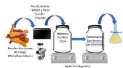
Ilustración 3. Proceso de la cáscara Mango ( Mangifera indica L) para la obtención del Bioetanol (Marín Carvajal, 2018).
