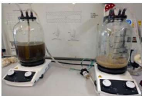
Ilustración 10. Proceso de fermentación alcohólica de la de la Eichhornia Crassipes o lirio acuático
