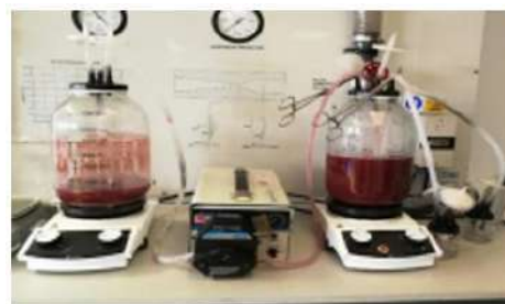
Ilustración 8. Proceso de fermentación alcohólica de la uva ( Vitis Vinífera )
