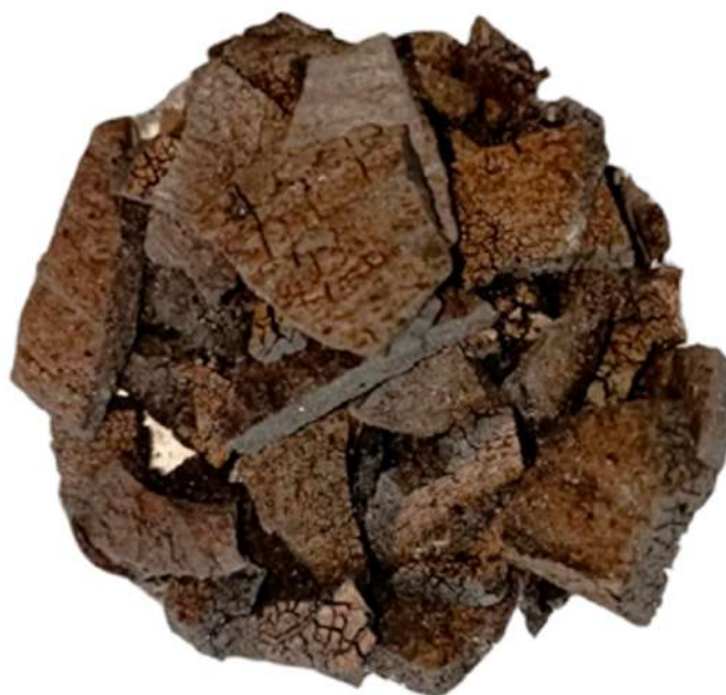
Figura 5. Endocarpio de semilla de cocotero carbonizado a una temperatura de 300°C
