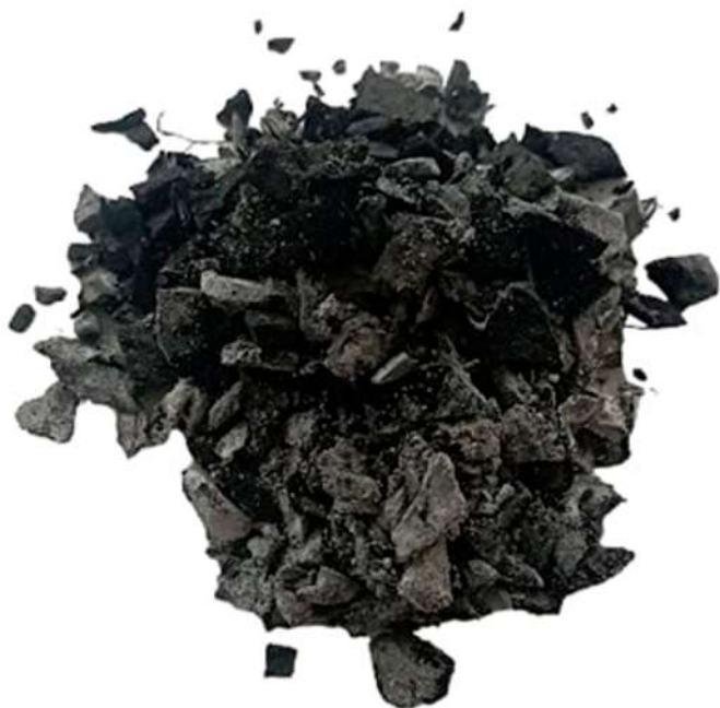
Figura 3. Endocarpio de semilla de cocotero carbonizado a temperaturas mayores de 300°C
