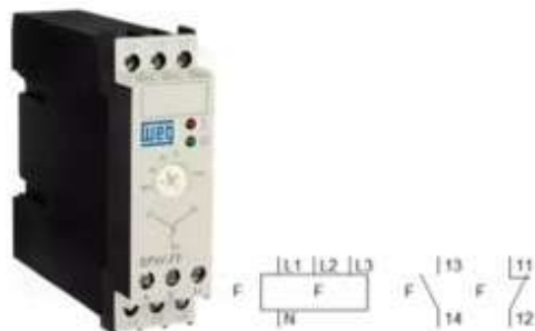
Ilustración 12 – Relevo falta de fase y simbología
