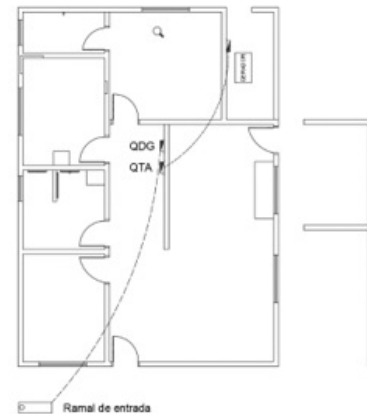
Ilustración 17 – Alimentación QDG y QTA
