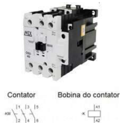
Ilustración 10 – Contactor de potencia y simbología
