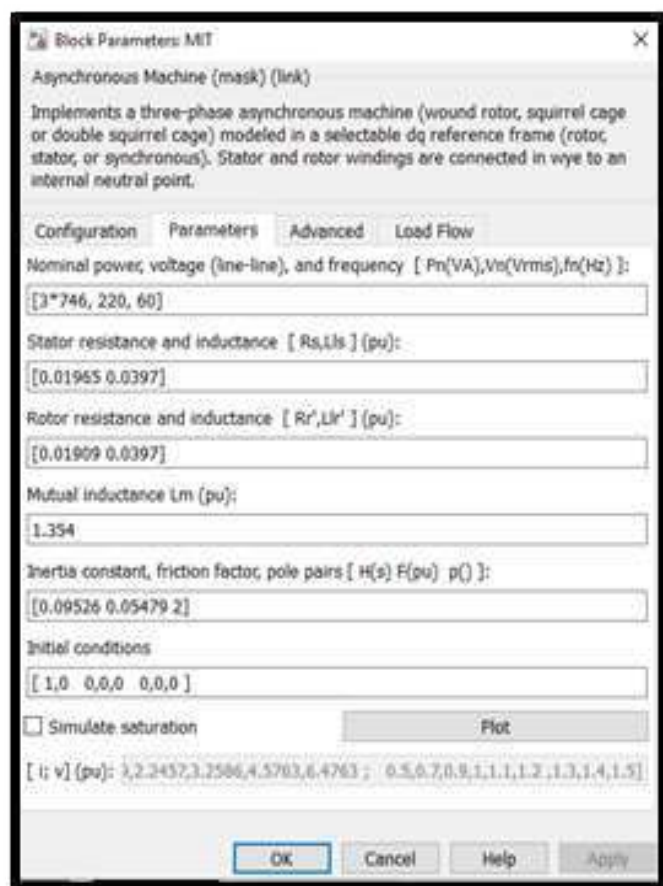
Figura 10- Configuración del motor
