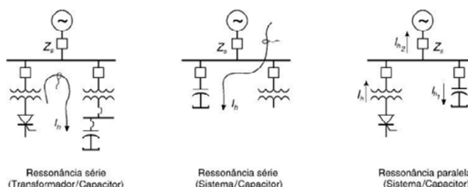
Figura 4. Resonancia en serie / paralelo
