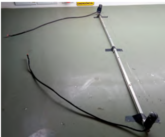
Figura 9 – Estrutura simulatória do circuito externo da cerca.
