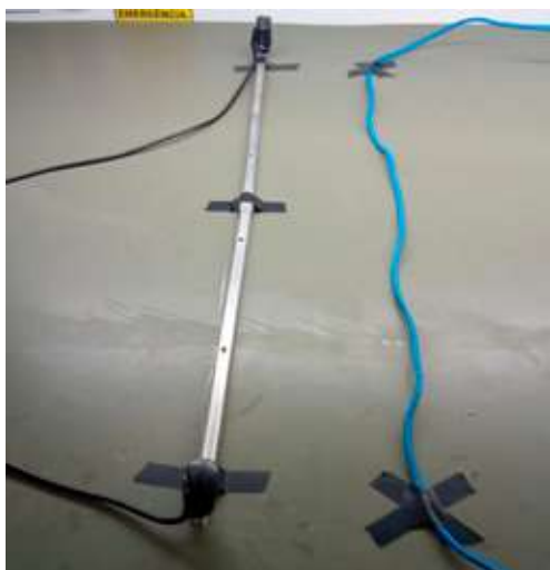
Figura 12 – Cabo vítima à uma distância média de quinze centímetros.
