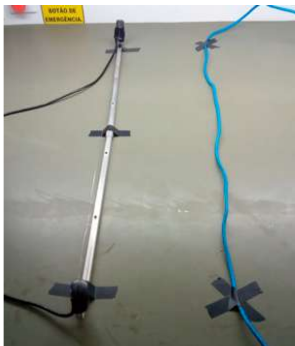
Figura 13 – Cabo vítima à uma distância média de vinte centímetros.
