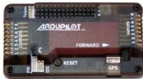
Figura 14: Microcontroladores utilizados em drones e rovers
