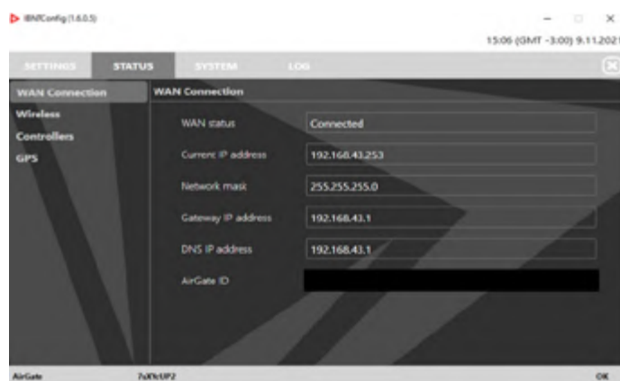
Figura 17 Status conexão de rede Ethernet IB-NT-Config.
