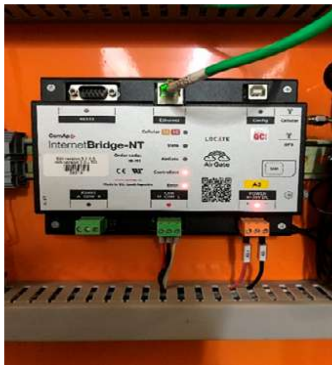
Figura 9 Módulo de comunicação ComAp InternetBridge-NT.
