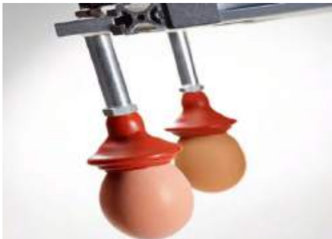
Imagen 15. Ventosas de fuelle aplicadas para la sujeción de los huevos
