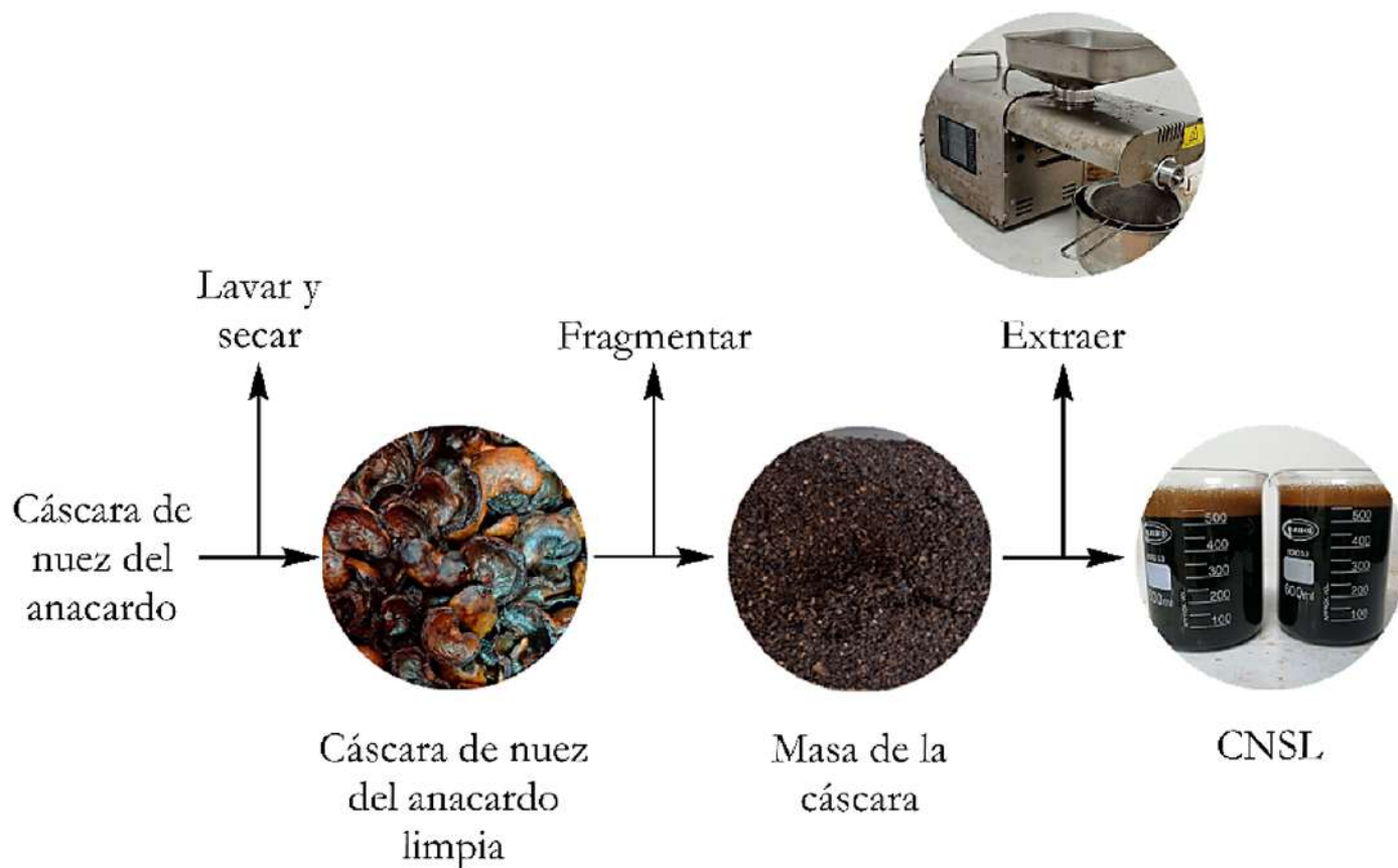
Figura 5. Diagrama de flujo para la extracción del CNSL
