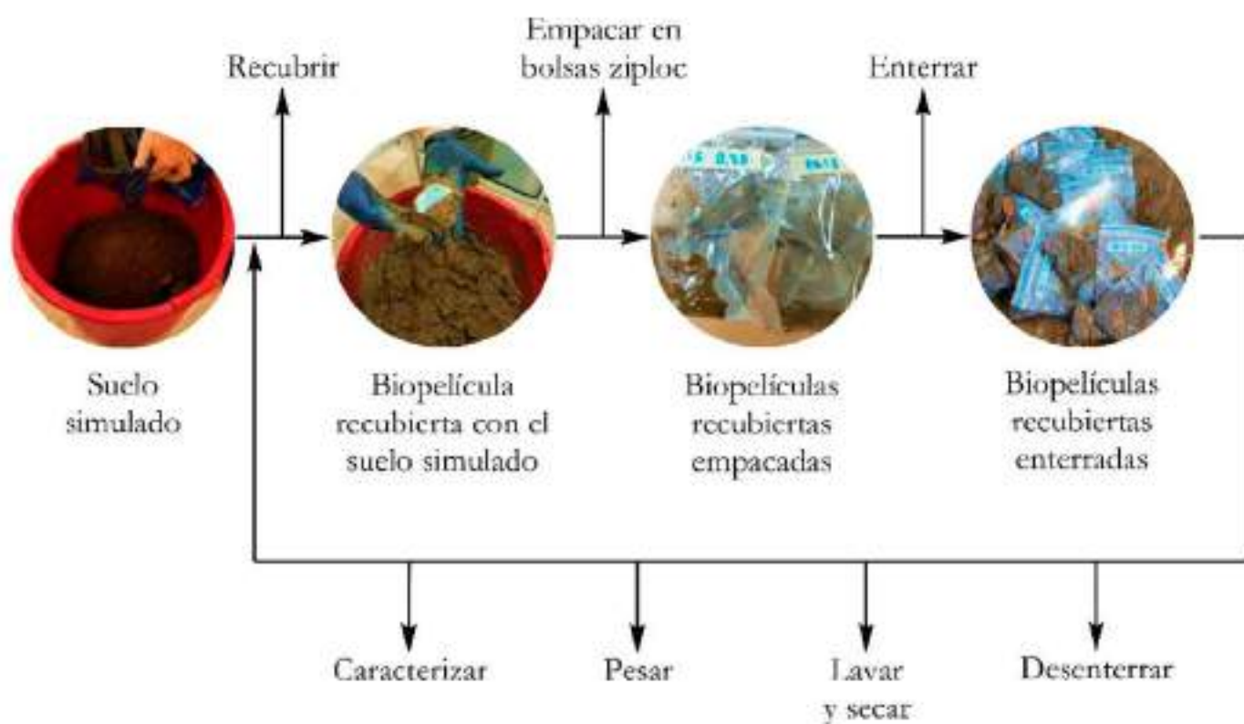
Figura 6. Representación esquemática del proceso de biodegradabilidad en suelo simulado
