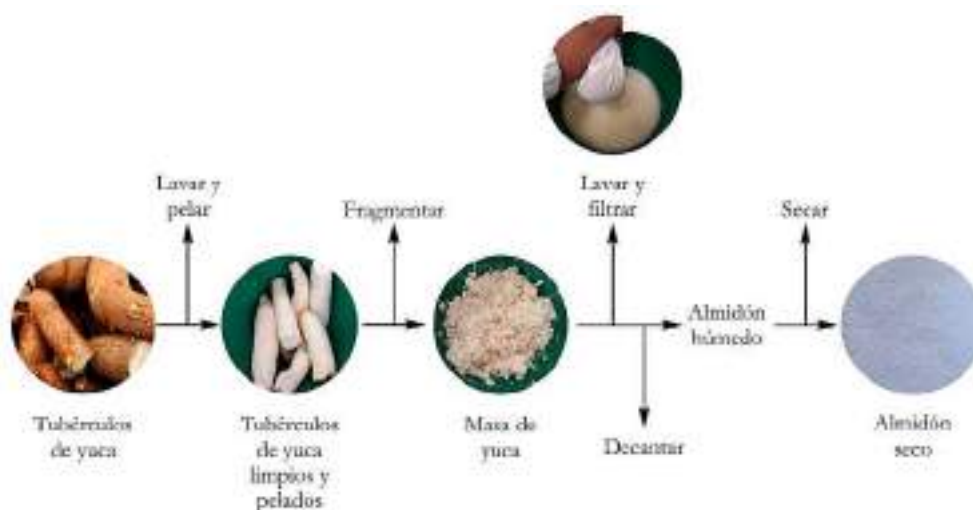
Figura 4. Diagrama de flujo para la extracción del almidón a partir de la yuca
